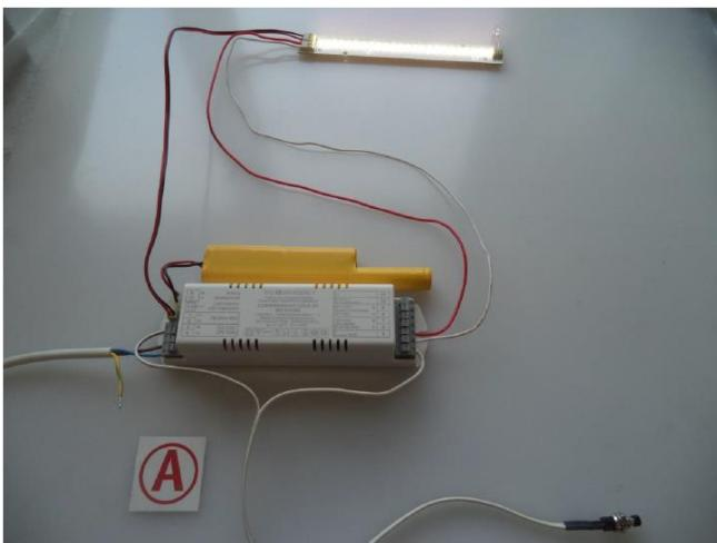
Если блок Telemando используется, функция тестирования аварийного режима осуществляется посредством использования кнопки теста. Кнопка теста подключается к разъему «КнопкаTEST» (правая часть блока) и разъему № 1 («-> Telemando), в левой части блока.
