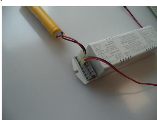
Аккумулятор обеспечивает питание аварийного LED модуля в аварийном режиме. Для К-301 продолжительность работы 1 час, для К-303 – 3 часа.
