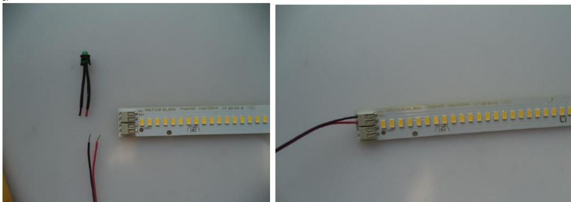
Чтобы обеспечить питание запасного тестового индикатора, его нужно запитать. Для этого отрезаем основной индикатор и подключаем провод в левый, верхний разъем «ind-» и «ind+». **Внимание:** важно не перепутать полярность - черный провод подключаем в разъем «-», красный в разъем «+».
