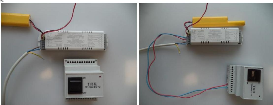
Для дистанционного тестирования работоспособности аварийных светильников можно использовать блок Telemundo. К блоку может быть подключено до 35 аварийных светильников. Без блока Telemundo, для тестирования можно использовать кнопку и индикатор (в комплекте)
