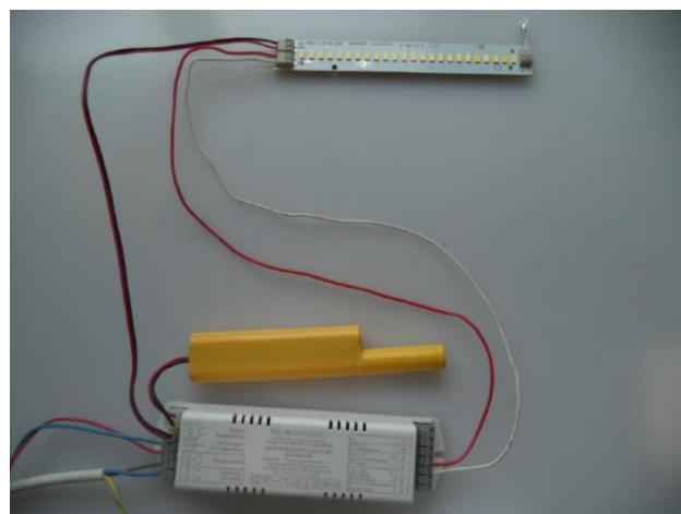
Освещение в аварийном режиме обеспечивает LED модуль. Модуль крепится двусторонним скотчем (в комплекте) на сам светильник (внутри или снаружи). Для подключения проводами соединяются разъемы № 6 («-») и №7 («+») блока с соответствующими разъемами LED модуля (слева, внизу).
