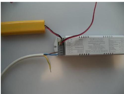
Для зарядки аккумулятора, блок аварийного питания должен быть подключен к сети 220В. Для этого подключаем питающий провод к разъему «220-230В».
