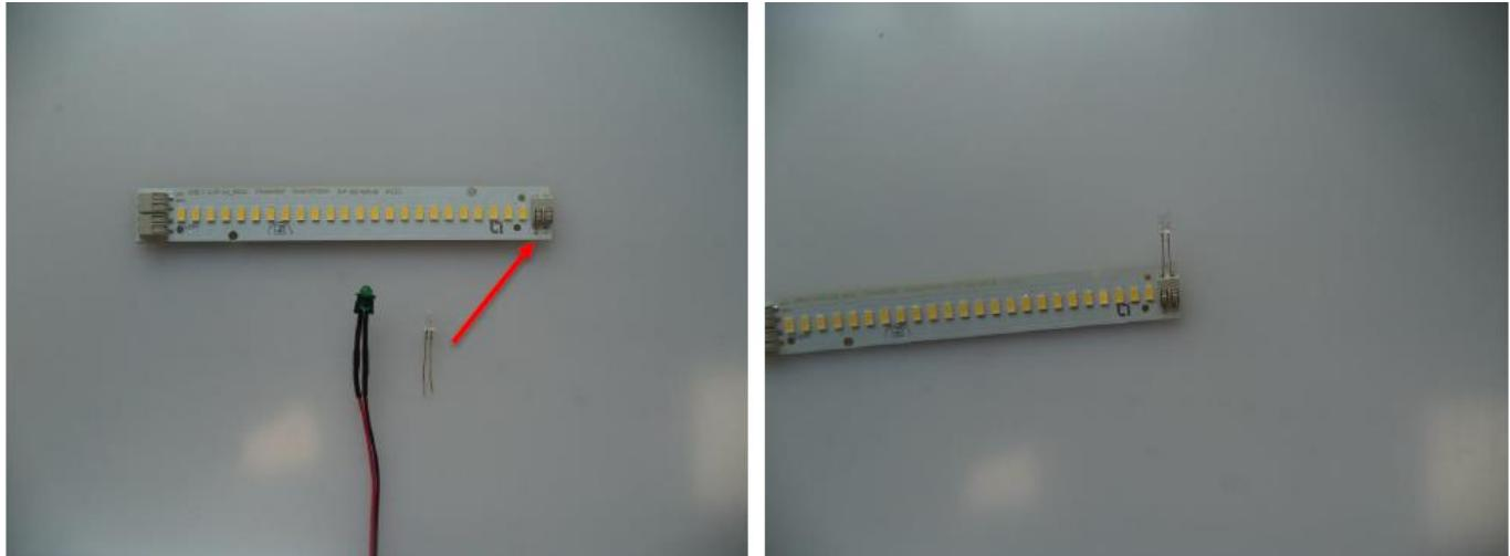
Вместо основного тестового индикатора можно подключить запасной (ходит в комплект поставки), в том случае, когда невозможно установить индикатор отдельно от LED модуля.
